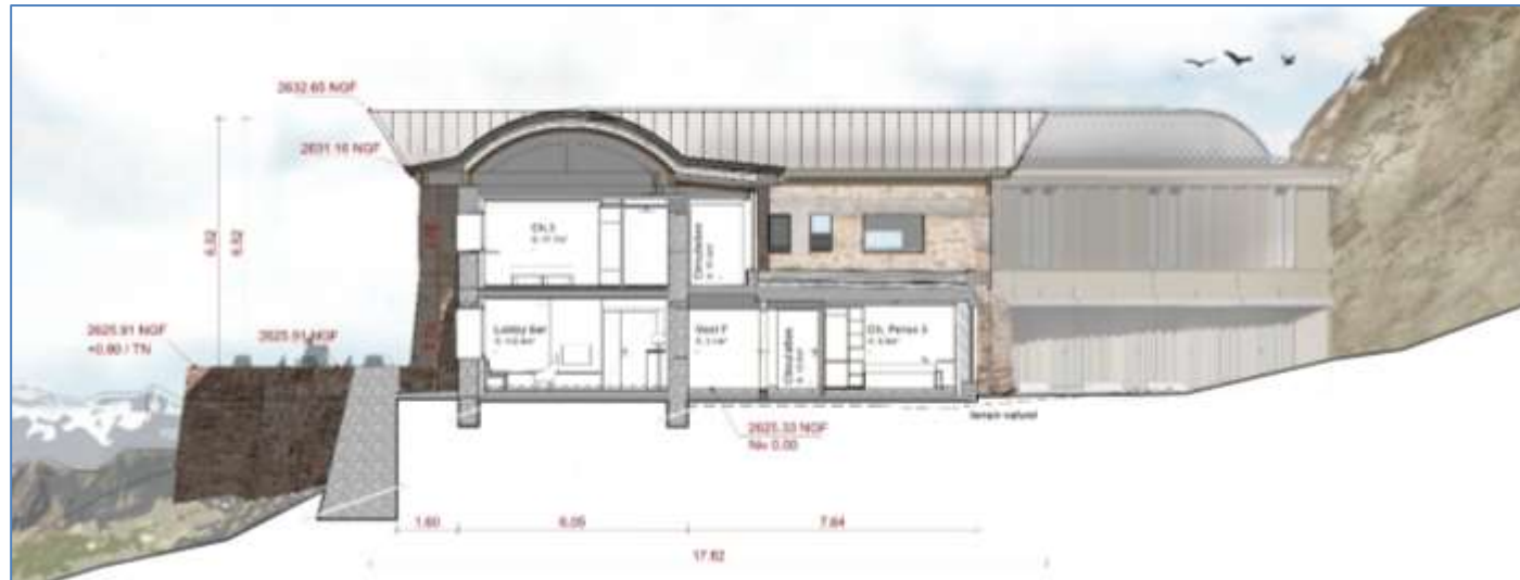
Illustration n° 5 : Coupe sur une chambre courante de l'existant
