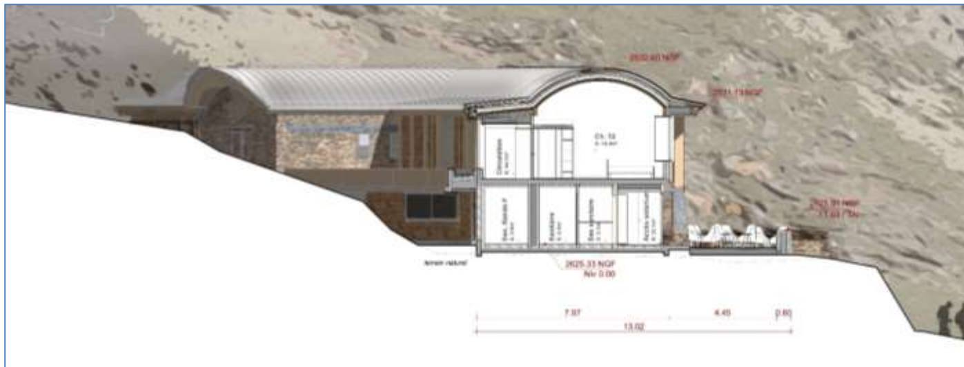
Illustration n° 19 : Coupe sur une chambre de l'extension
