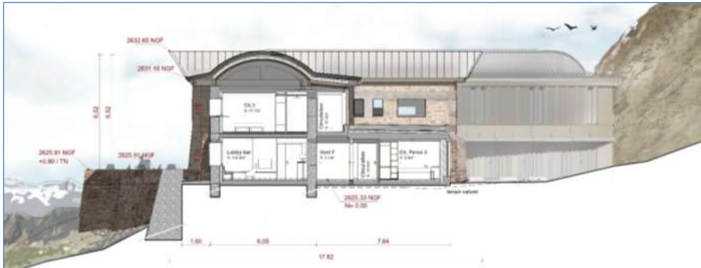
Illustration n° 18 : Coupe sur une chambre courante de l'existant
